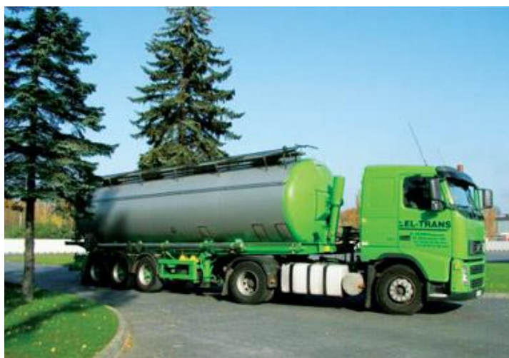
Rys. 11. Pojazd do transportu ładunków niebezpiecznych firmy EL-TRANS. Naczepa typu cysterna 1-komorowa [16]
